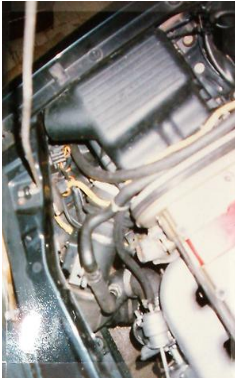
Bild 5.8a Luftfilterkastenänderung und Ansaugänderung
