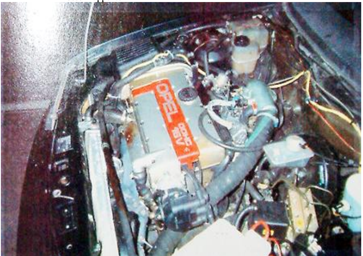
Bild 5.9e Druckschlauch mit Anschluß zum Drosselklappenteil
