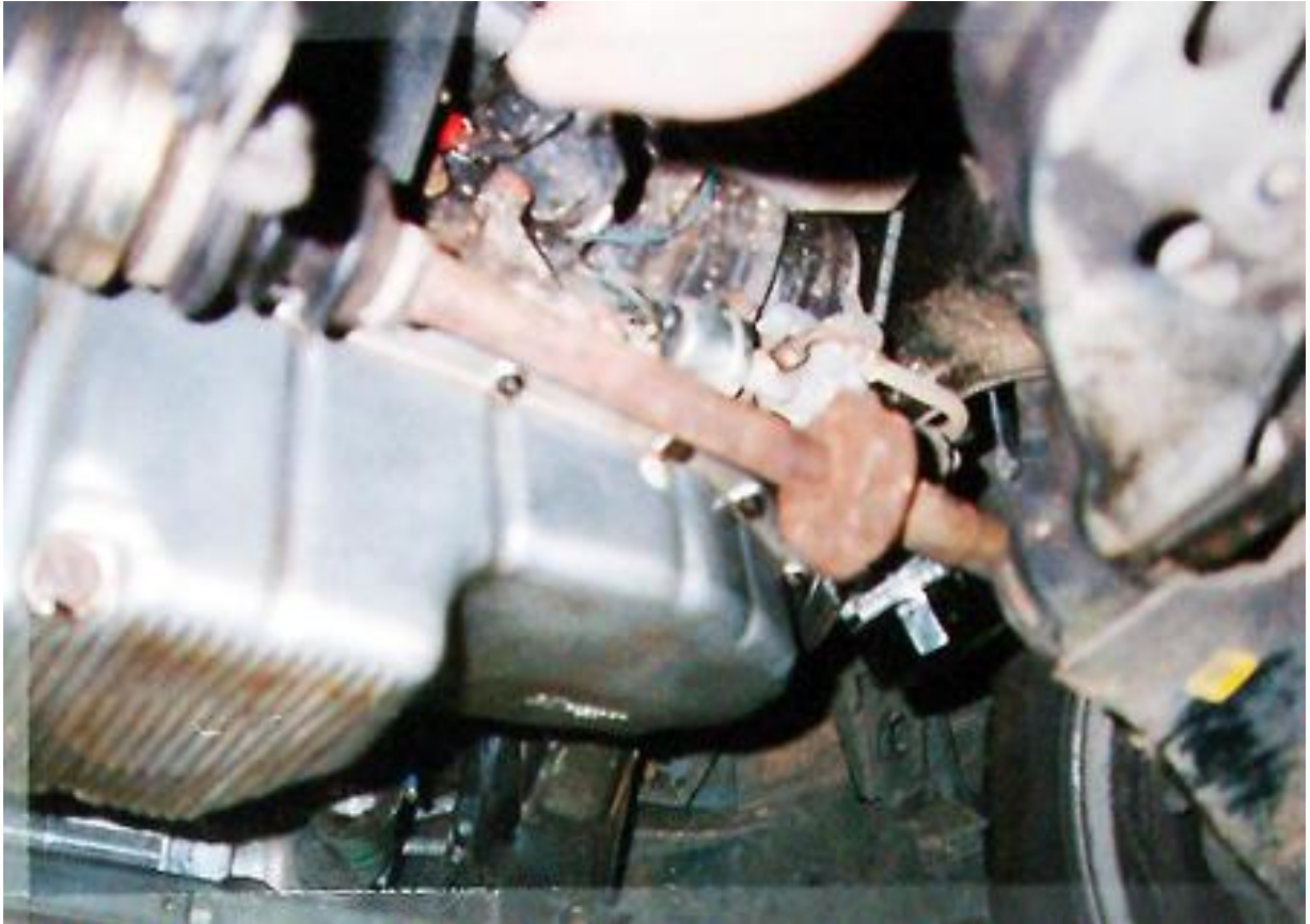
Bild 5.6a (15) Anschluß der Ölzufuhrleitung vom Öldruckschalter zum Turbolader
